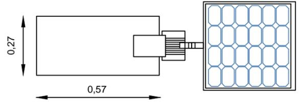
lampione fotovoltaico con corpo illuminante a LED, pannello fotovoltaico 25W e palo h 3,00 m in acciaio zincato a caldo
